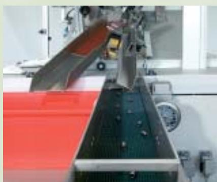
Die guten und schlechten Teile werden getrennt sortiert (über Weiche), abgeführt und ein Prüfprotokoll erstellt.
