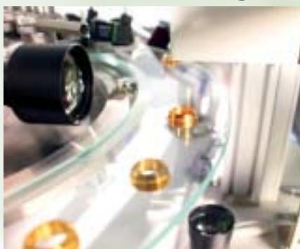
Die Teile werden auf einen Glasteller gesetzt und dort von 1 – 5 hochauflösenden Kameras gescannt und kontrolliert. Es erfolgt das gleichzeitige Vermessen von Außenmaßen und Formüberprüfung mit einem Durchsatz von bis zu 300 Teilen pro Minute.
