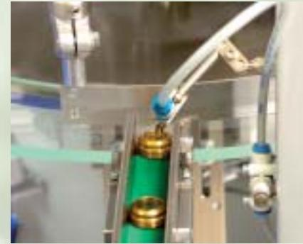
Durch einen Vibrationswendelförderer werden die Teile separiert und in gleichen Abständen auf ein Laufband gelegt.
