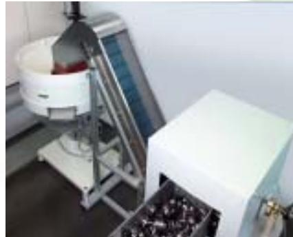
Für die automatisierte und schonende Zuführung der Teile wird ein Steilförderer mit Bunker eingesetzt. Er fasst 80 – 500 kg.
